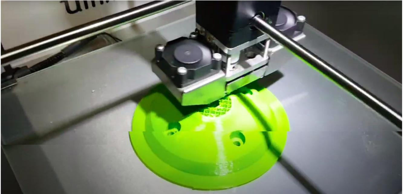
Imagen 12. Impresión del plato soporte para el trípode.
