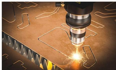
**Imagen 1** *Máquina láser cnc para corte*
