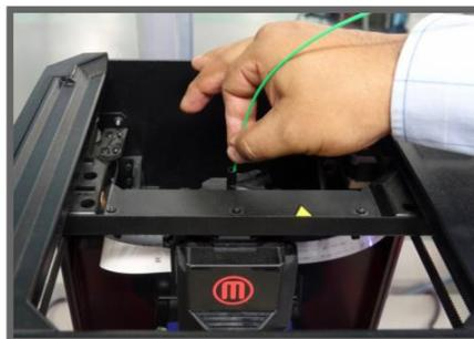
Fotografía 6 | Carga del filamento en la impresora
