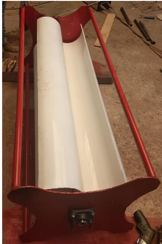
Pintado del prototipo con esmalte para evitar la corrosión.
